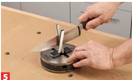
**5** ... nach außen. Die Klinge befeuchten und kreisend durch die Schleifstäbe ziehen.
